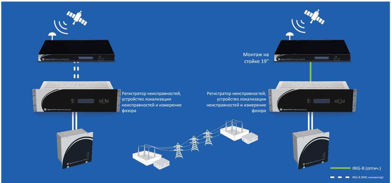
Рисунок 17: Применение TWFL с использованием RT430/434 для синхронизации времени
