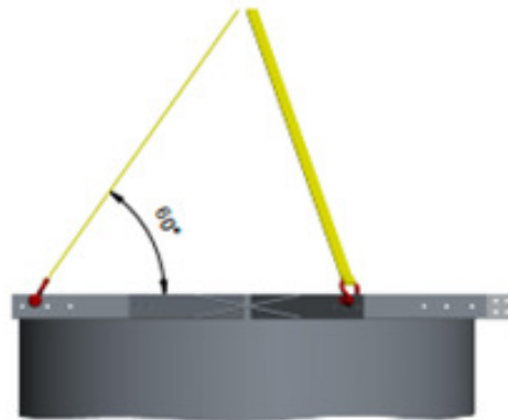
Içamento por três pontos
