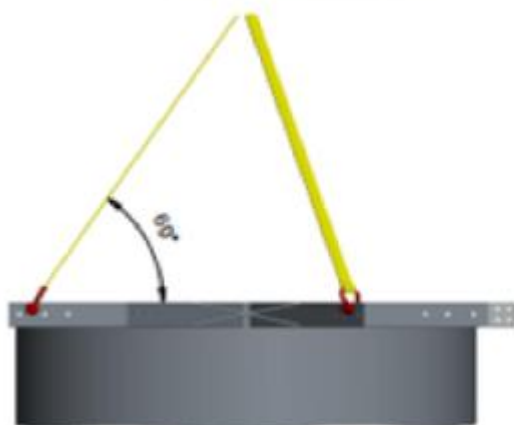
Izamento por tres puntos
