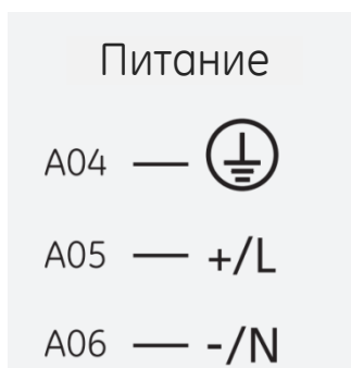
Подключение питания переменным и постоянным током
