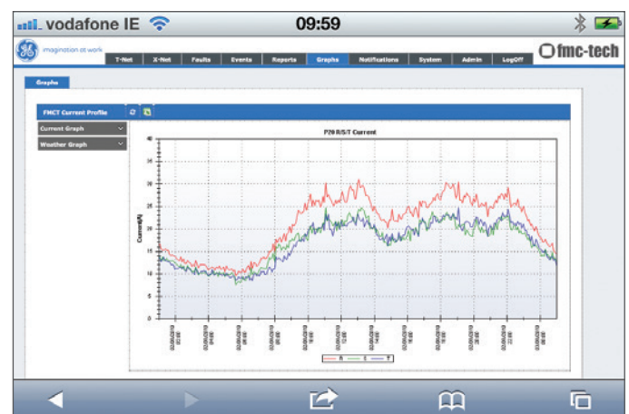
Charakterystyki obciążenia linii pokazują wielkość asymetrii obciążenia poszczególnych segmentów linii zasilających
